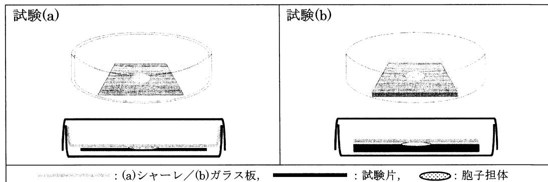
図 1 試験片の設置状況
